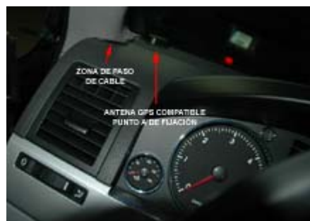
Paso cable GPS - Zona Salpicadero
