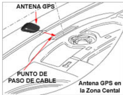
Antena GPS en zona central
