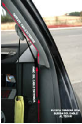
Subida al Techo, Cable Extensor
