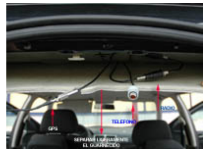
Instalación Triplex, Conexiones
