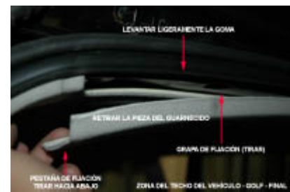
Triplex, Retirar banda guarnecido techo
