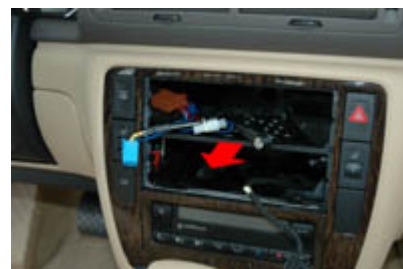
Passat, Conexiones originales
