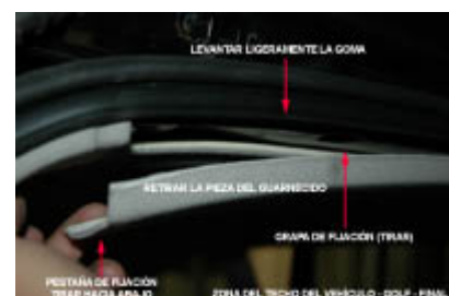
Triplex, Retirar banda guarnecido techo
