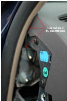
Passat, Paso de Cable Antena
