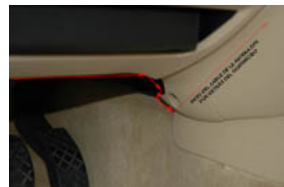
Passat, Paso de Cable Antena
