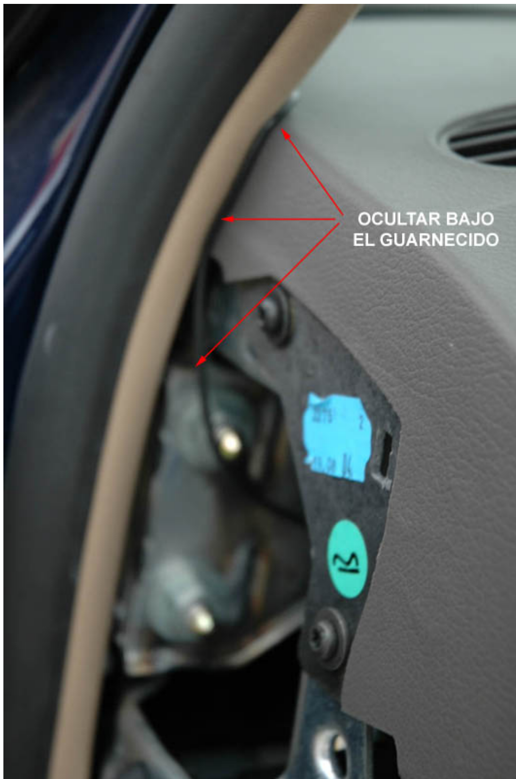
Passat, Paso de Cable Antena
