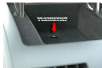
Tornillo fijación guardaobjetos
