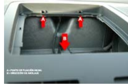
Extracción del Guardaobjetos
