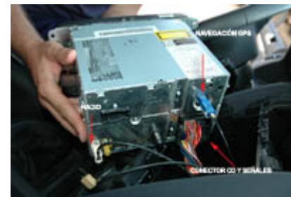
Conectores MFD2 Fijados
