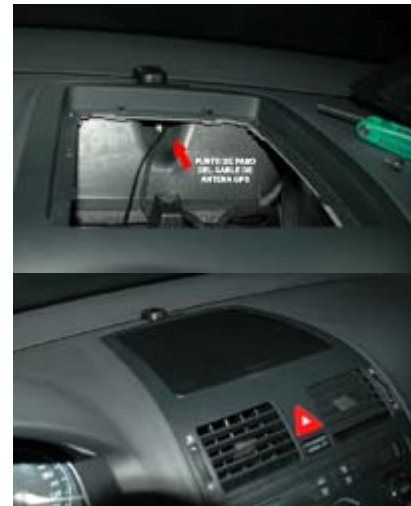
Antena GPS Montada
