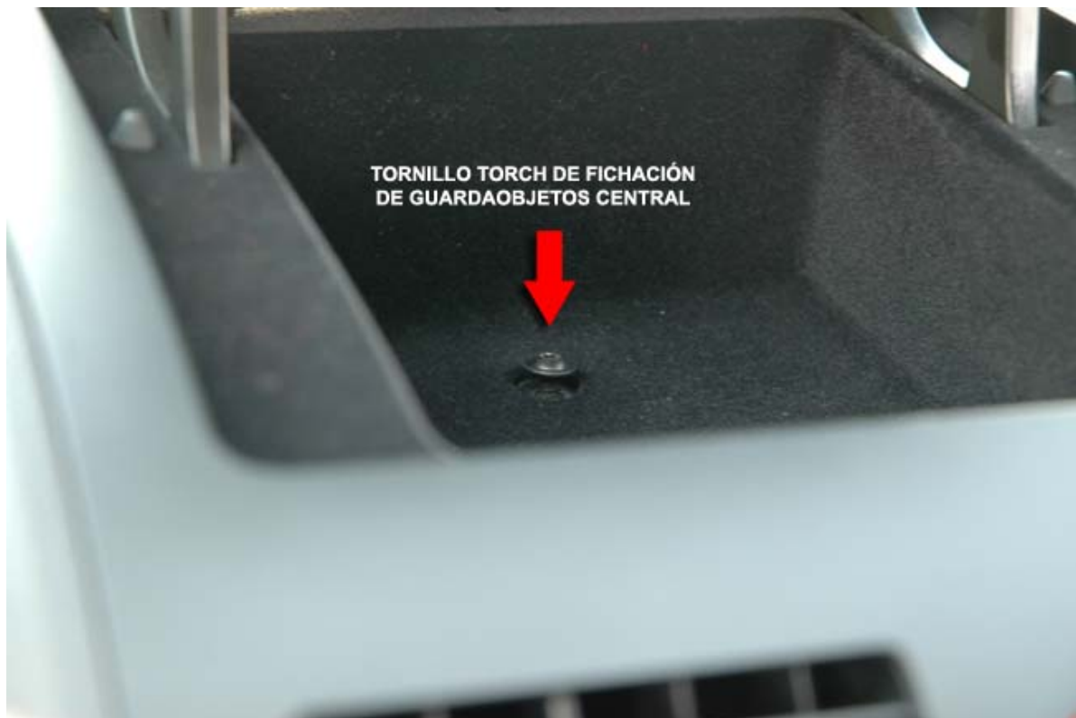
Tornillo fijación guardabojos
