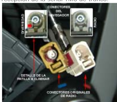
Detalle Conectores originales
