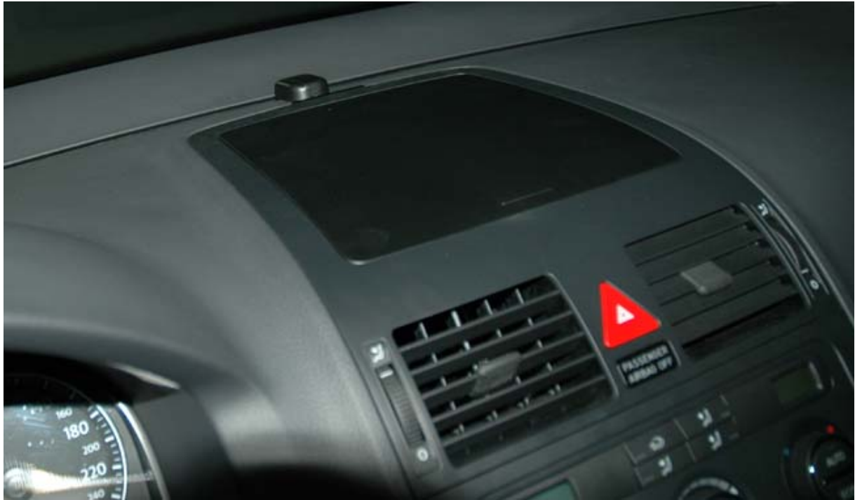
Antena GPS Montada
